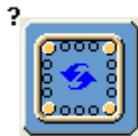
Выберите вариант симметрии. С помощью условий симметрии можно определить, какие угловые стержни имеют одинаковые марку, размер и радиус изгиба. Угловые стержни с одинаковыми свойствами — это симметричные стержни.
