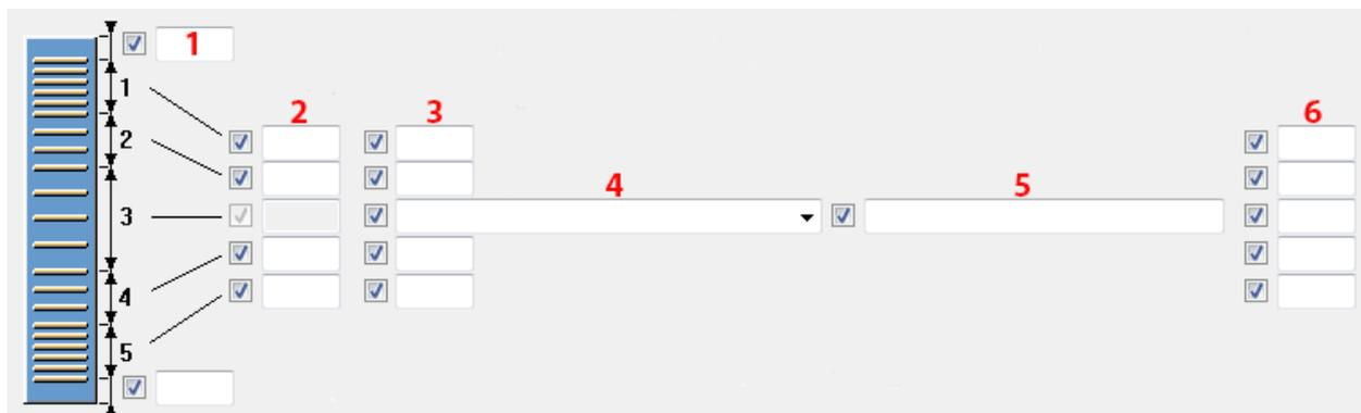
1. Задайте толщину защитного слоя бетона над хомутами вверху и внизу колонны. Толщина защитного слоя по умолчанию — 50 мм.
