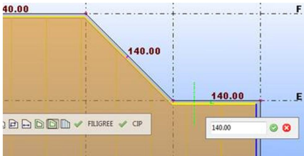
Обратите внимание, что при использовании команды смещения на панели инструментов прямого изменения отображаются слои компоновки межэтажного перекрытия. Каждый слой может иметь разные смещения. Можно выбрать, какие слои требуется изменить. Самый простой способ — выбрать все слои и задать равные смещения для каждого слоя.
