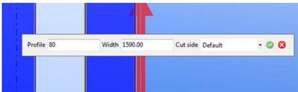
Если профиль плиты перекрытия фиксированный (не параметрический), плита перекрытия срезается с обеих сторон, когда ширина меньше исходной ширины. Сторона срезаания **По умолчанию** — это передняя кромка для первой плиты и задняя кромка для всех остальных, относительно направления компоновки.
