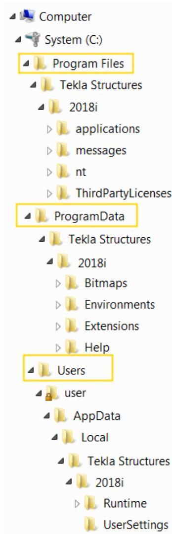
На рисунке ниже показана структура папок установки на диске C:\. Если программа Tekla Structures устанавливается на диске C:\, среды также устанавливаются на диск C:\ (там же сохраняются настройки пользователя).
