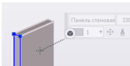
3. Перетащите контекстную панель инструментов в новое положение. Например, контекстную панель инструментов можно расположить слева от выбранного объекта.
