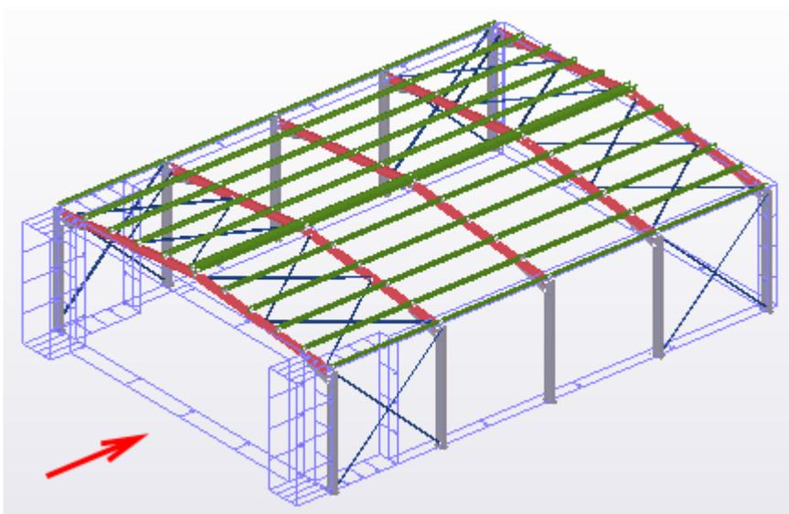
Нагрузки, вызываемые ветром в направлении глобальной оси X, умножаются на 3 в обоих углах стены 1 (наветренной стены) и в противоположном углу стен 2 и 4 (боковых стен). Ширины зон определены с помощью размеров.
