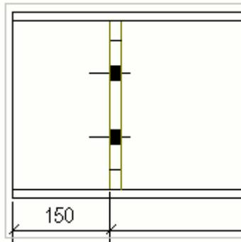
Ниже приведен пример простановки размеров пластин до задней кромки.
