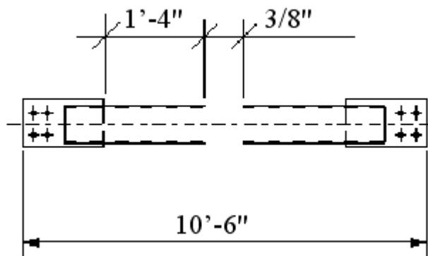
Следующий пример иллюстрирует параметры **Минимальная длина усекаемой детали**, **Расстояние между усеченными деталями**, а также зону детали, которая не считается пустой, из-за чего деталь не разрезается. Параметр **Минимальная длина усекаемой детали** задан равным 650 — это означает, что деталь укорачивается на виде в точке, где ее длина достигает 650.
