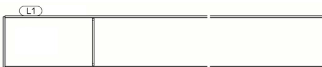
Метки располагаются с одной и той же стороны вне зависимости от ориентации балок:
