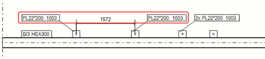
В приведенном ниже примере метки деталей в направлении оси Y не объединены, потому что метки объединяются только в направлении оси X.
