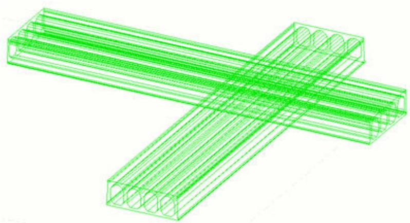
Ниже приведен пример **контурного** представления. Для параметров **Скрытые линии** и **Собственные скрытые линии** установлено значение **откл.**:
