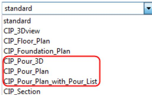
Следующий пример чертежа создан с использованием свойств чертежа CIP\_Pour\_Plan\_with\_Pour\_List, с применением к 3D-видам свойств уровня вида CIP\_Pour\_3D. Щелкните следующую ссылку, чтобы открыть чертеж:
