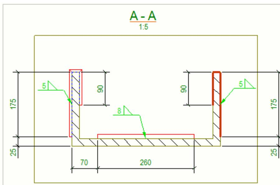
*Символы сварки* внутри меток сварных швов указывают на свойства, заданные для сварного шва в модели или для метки сварного шва на чертеже. Ниже приведен пример сварного стыка модели (обозначен
