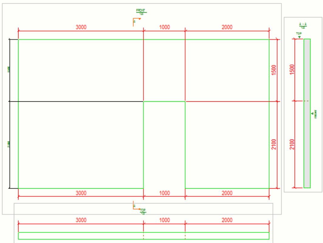
Ниже приведен пример отверстия в объекте модели и размеров на чертеже.
