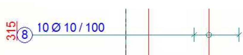
Ниже приведен пример тега размера без поворота и с поворотом:
