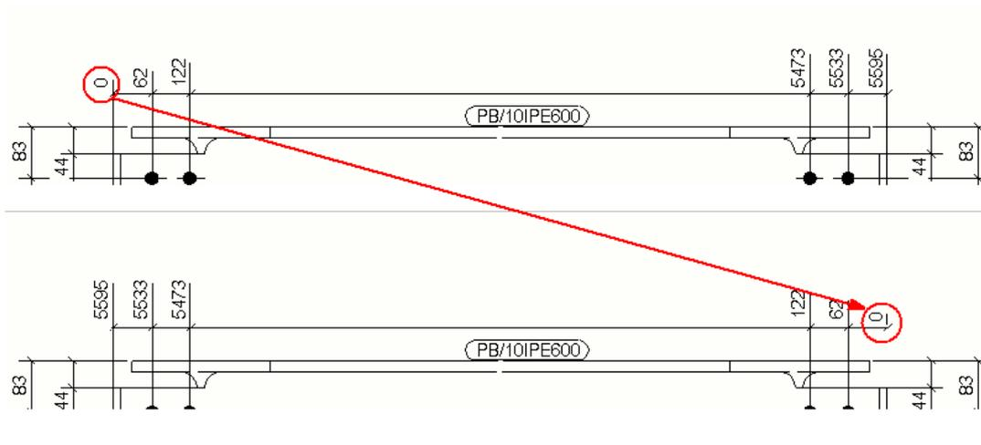
При использовании размеров типа «Абсолютный, США» Tekla Structures вычерчивает новый символ RD (Running Dimension — последовательность размеров) в новой нулевой точке и обновляет выбранные размеры в соответствии с новой начальной точкой.
