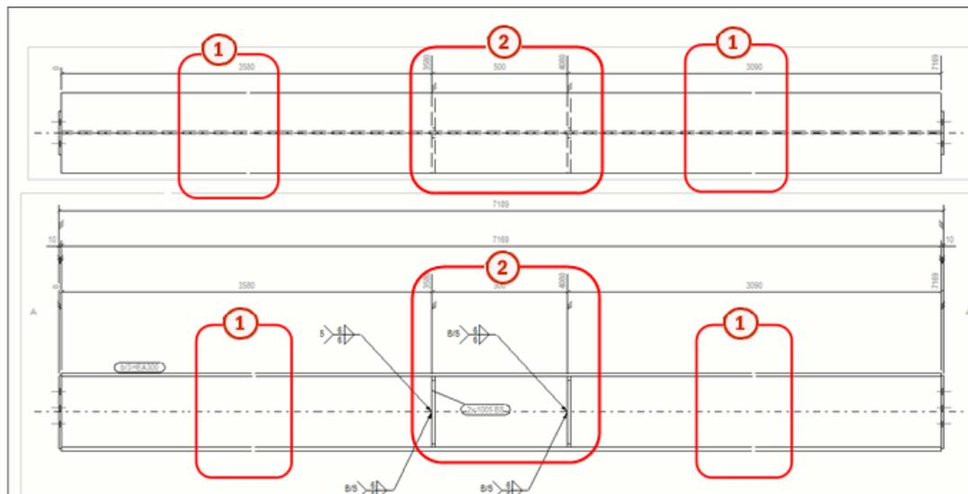
1. Параметр **Расстояние между усеченными деталями** задан равным 1. Этот параметр определяет расстояние между двумя частями разрезанной детали на бумаге (не в модели).
