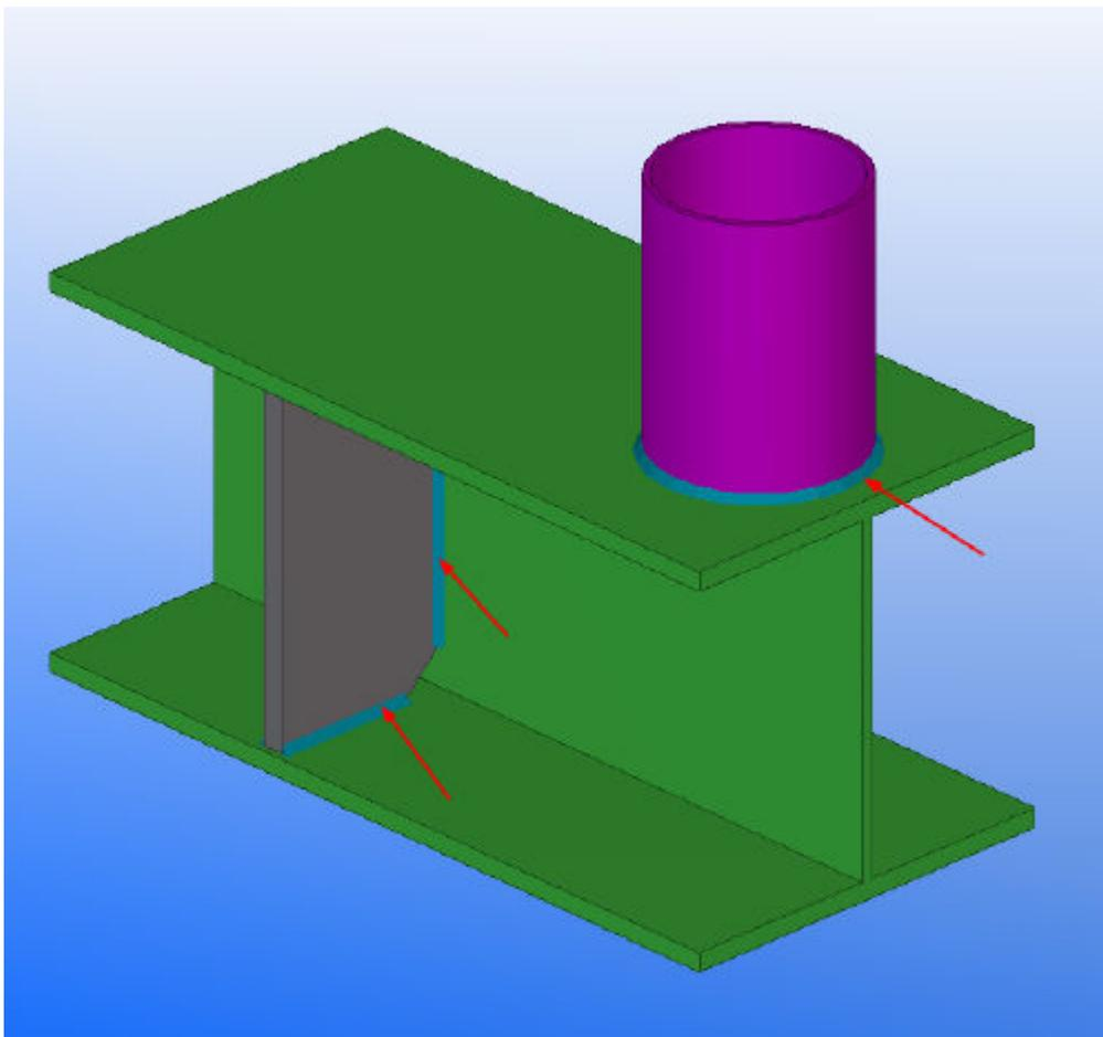
На втором рисунке показаны метки сварного шва модели на чертеже. Темно-зеленым цветом обозначена область, в пределах которой можно перетаскивать базовую точку линии выноски меток сварных швов.
