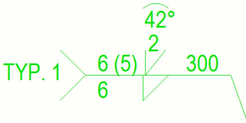
Во втором примере скрыты все свойства метки сварного шва, кроме свойства **Тип** из разделов **Над линией** и **Под линией** и свойства **Примечание** из раздела **Другое**.
