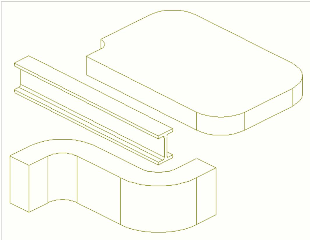
Ниже приведен пример деталей на чертеже с невидимыми кромками сопряжений (**Кромки сопряжений > откл.**).
