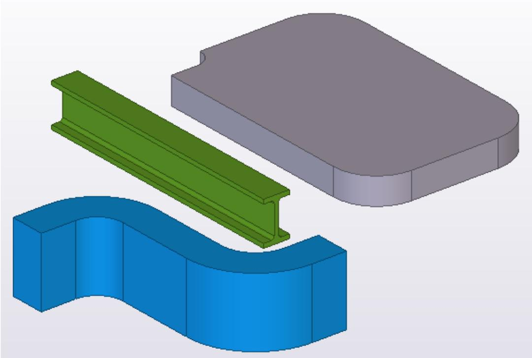
Ниже приведен пример деталей на чертеже с видимыми кромками сопряжений (**Кромки сопряжений > вкл.**).
