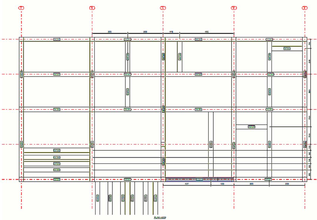
В примере ниже для параметра **Горизонтальное положение** задано значение **Распределен на обе стороны**: все размеры горизонтальных деталей располагаются со стороны сетки, ближайшей к измеряемой детали.
