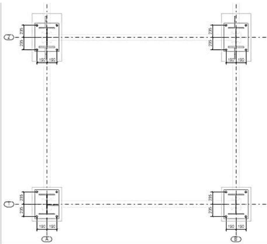
Если опорная точка колонны не лежит на линии сетки, Tekla Structures автоматически проставляет размеры опорной точки относительно линий сетки. См. пример ниже.
