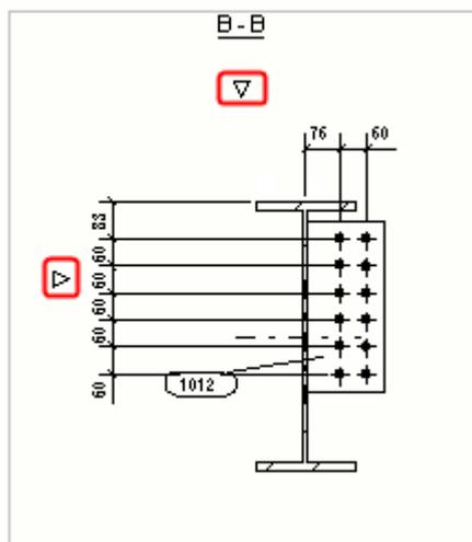
Положение метки ориентации вида соответствует настройке положения подписи вида. На рисунке ниже для подписи вида выбран вариант **Центральное позиционирование в ограниченном пространстве вида**.
