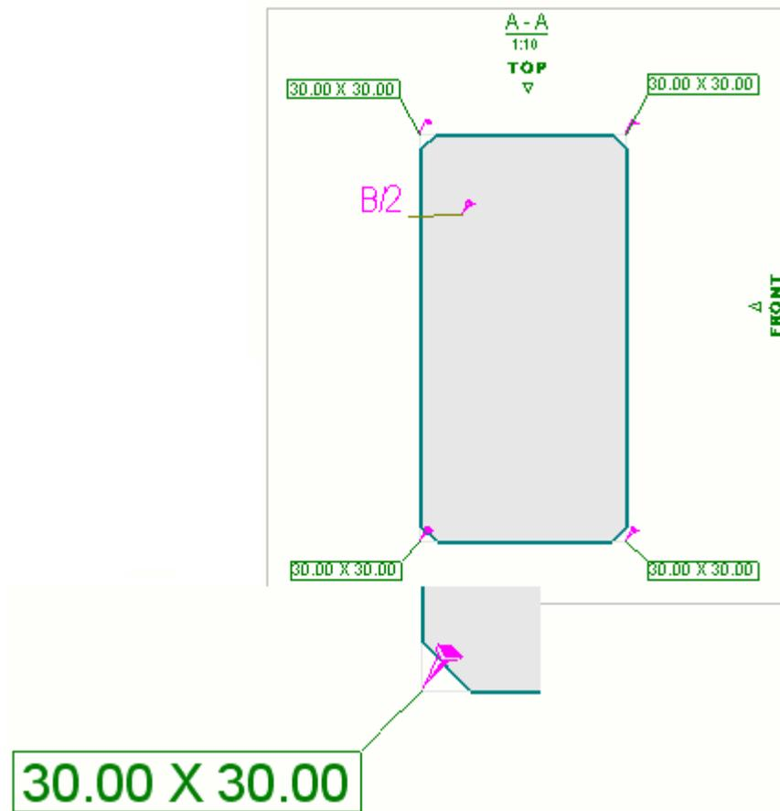
Во втором примере для параметра **Представление детали** задано значение **Контур**, а для параметра **Фаски кромки** — значение **вкл.** В качестве цвета линий фасок используется цвет фона: может потребоваться просматривать и выбирать фаски на чертеже, например для добавления ассоциативных примечаний. Это представление часто используется, если масштаб мелкий и четкое изображение мелких фасок не требуется. В правом нижнем углу рисунка показано, как выглядит фаска кромки при выборе.
