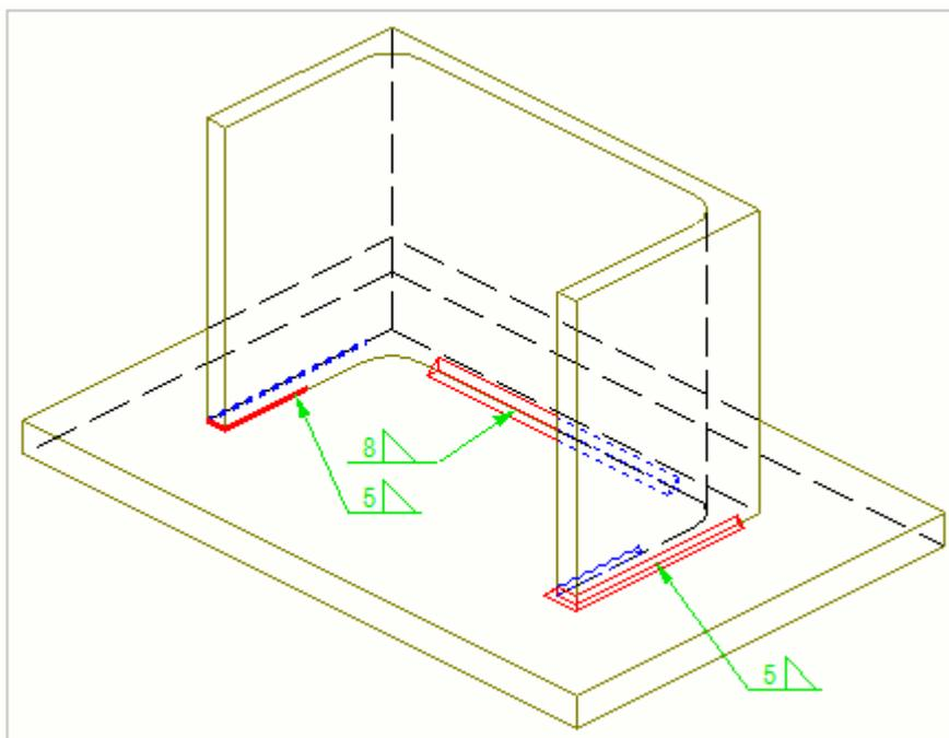
Второй пример — поперечное сечение структуры. Сварные швы слева и посередине имеют контуры, а сварной шов справа отображается в виде кривой. Сварные швы справа и слева проходят вокруг угла детали. Для сварных швов размеры проставляются вручную.
