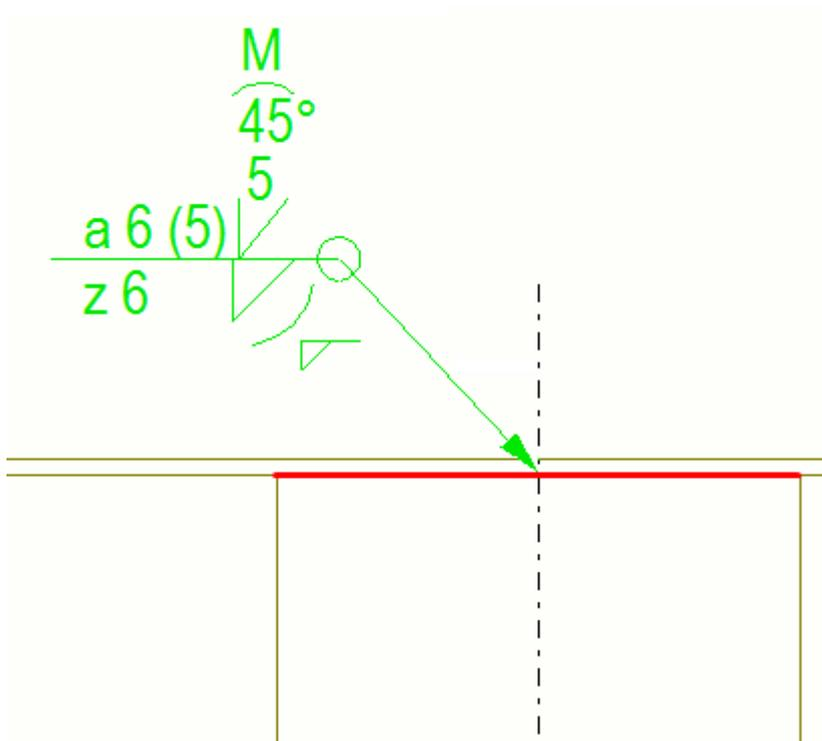
Помимо символов сварки, метка сварного шва также содержит опорную линию и стрелку. Стрелка соединяет опорную линию со *стороной соединения со стрелкой*. Сварные швы на стороне стрелки и на *другой стороне* детали могут иметь разные свойства сварки.
