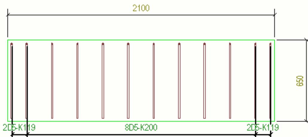
Ниже приведен пример размера армирования, содержащего метки размера и тег размера.
