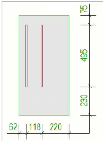
Если требуется нанести показать разные размеры арматурных стержней на отдельных размерных линиях, выберите в списке **Объединять на одной линии** вариант **По номеру позиции**:
