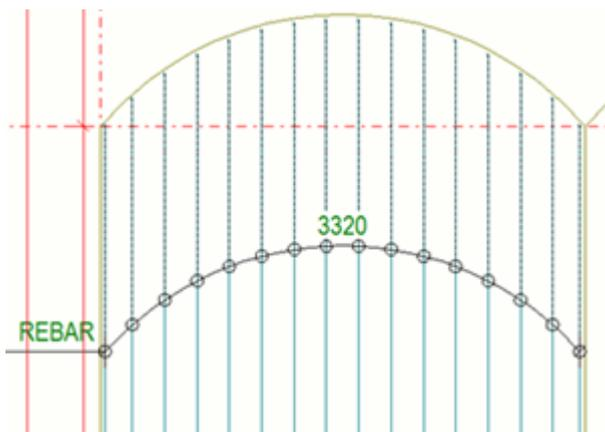
Ниже приведен пример ортогонального размера группы радиально изогнутых арматурных стержней.
