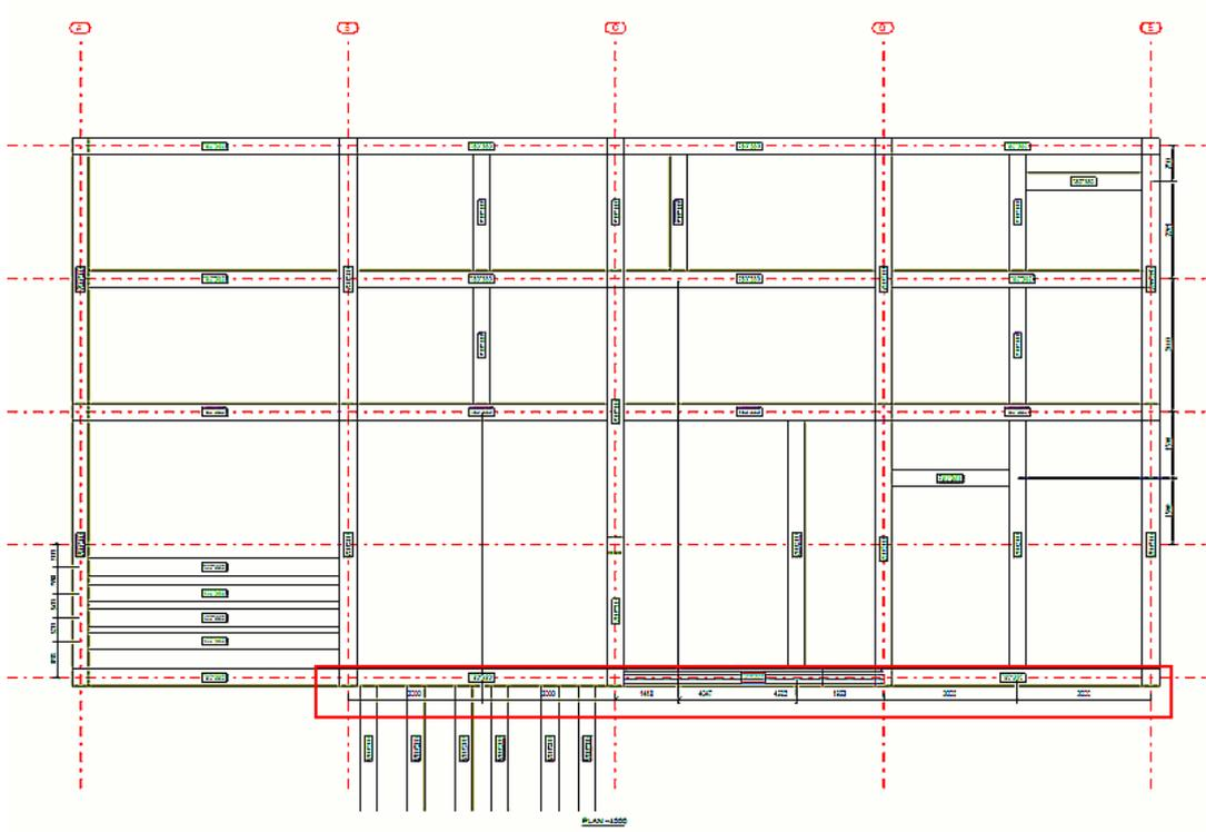
В примере ниже для параметра **Вертикальное положение** задано значение **Распределен на обе стороны**: все размеры вертикальных деталей располагаются со стороны сетки, ближайшей к измеряемой детали.
