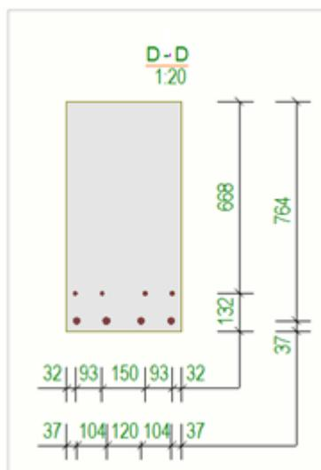
Чтобы облегчить создание правил, вариант «средняя точка» в списке **Проставлять размерные линии до** работает так, что размеры проставляются до начальной и конечной точек тех арматурных стержней, которые параллельны плоскости вида:
