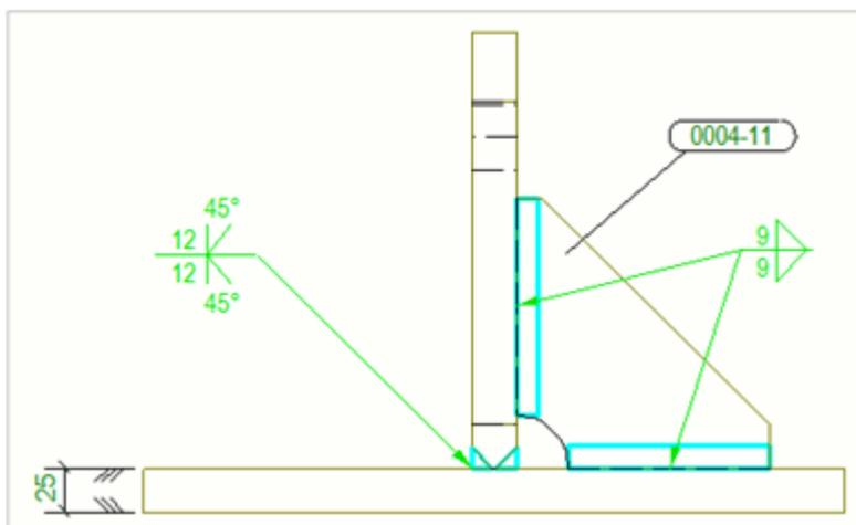
В следующем примере пользовательское представление **Corners Only** используется для лазерной проекционной разметки. Нанесение всех линий детали замедляет лазер, снижая яркость луча на разметочном столе.
