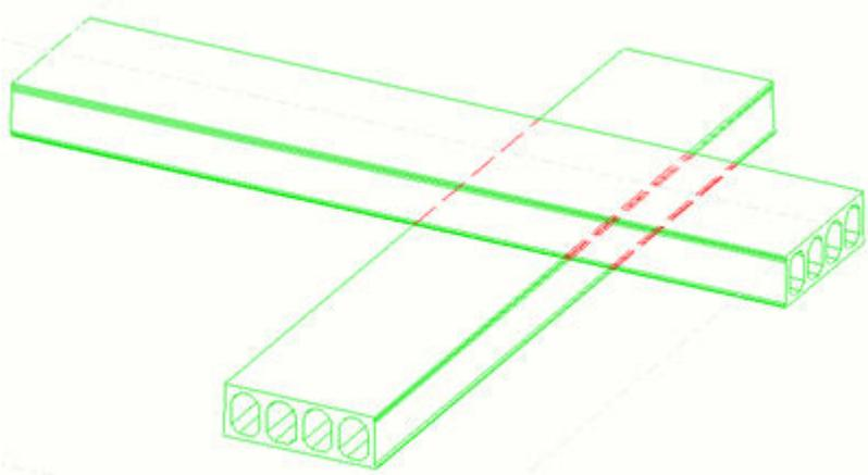
Ниже приведен пример **контурного** представления. Для параметров **Скрытые линии** и **Собственные скрытые линии** установлено значение **вкл.**, и они отображаются красным цветом.
