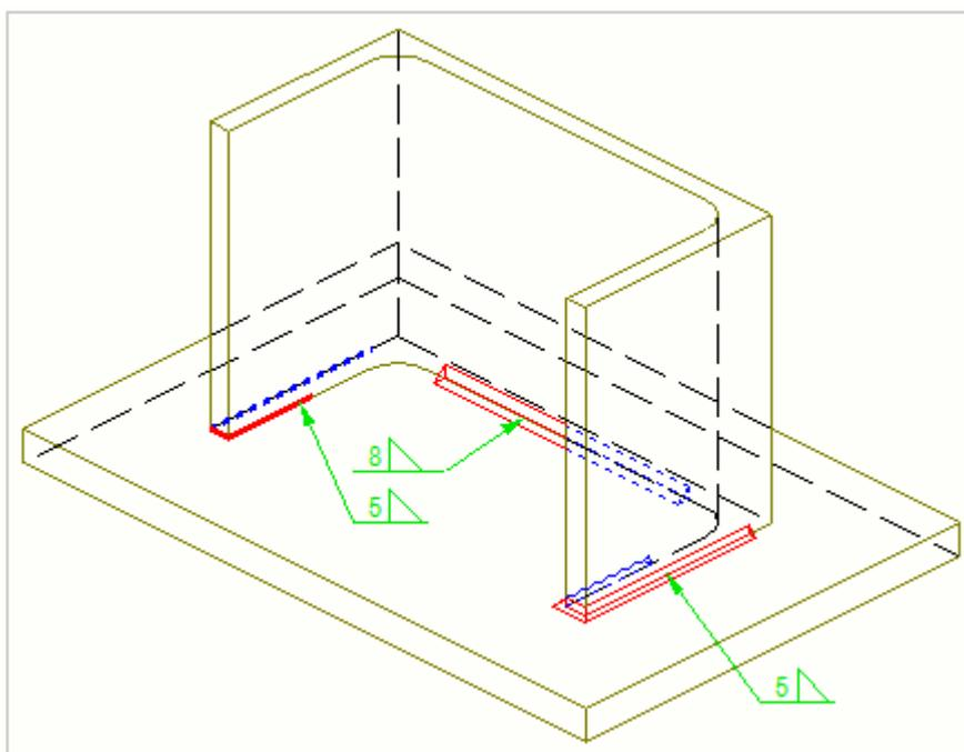
Второй пример — поперечное сечение структуры. Сварные швы слева и посередине имеют контуры, а сварной шов справа отображается в виде кривой. Для сварных швов размеры проставляются вручную.
