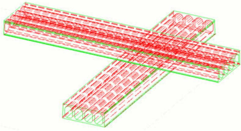
Ниже приведен пример отображения деталей с опорными моделями. Видимые линии опорной модели отображаются зеленым цветом, а скрытые линии — красным. Видимые линии детали отображаются синим цветом, а скрытые линии — голубым.
