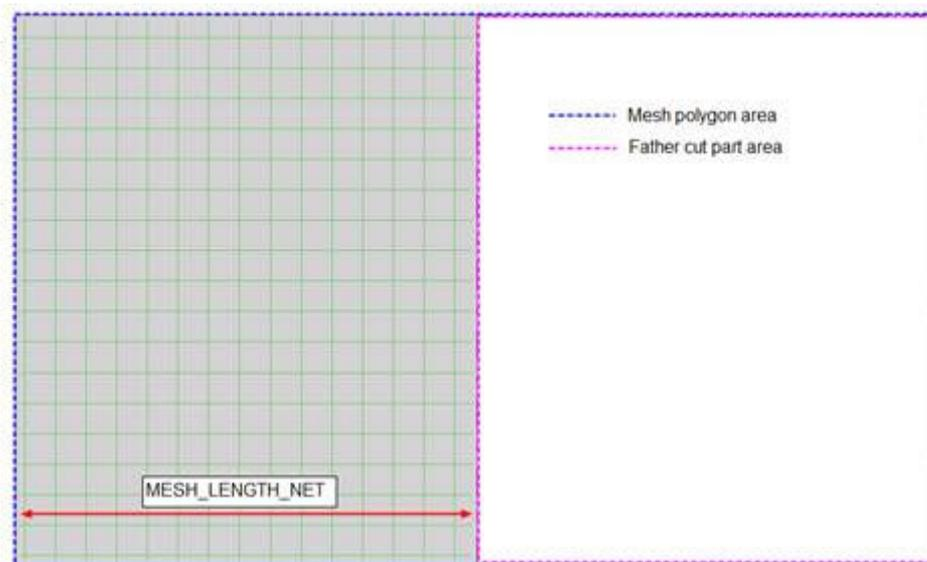
При запросе размера в Tekla Structures размер выводится так, что в первую очередь выводится высота, а в последнюю — длина; атрибут MESH\_SIZE\_NET выводит в первую очередь длину, а в последнюю ширину. 20/8-100/200-5950/2950 .
