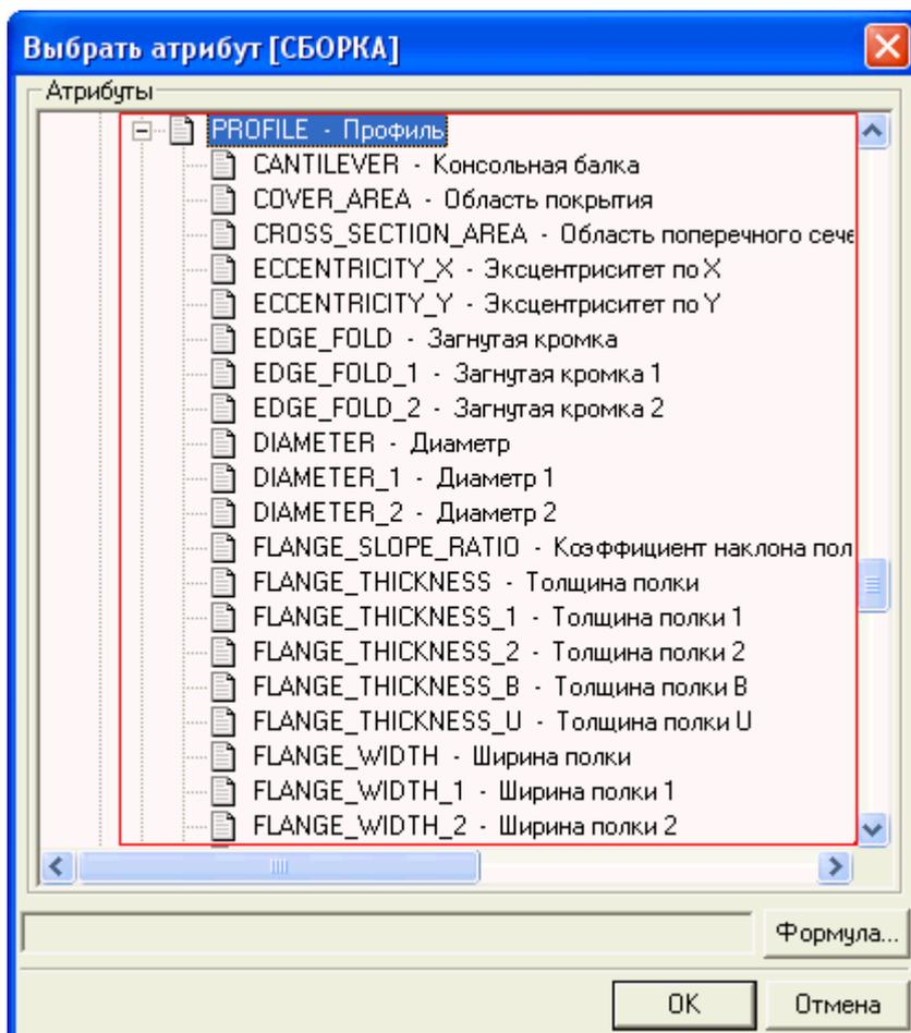
Например, MAINPART.PROFILE.HEIGHT с типом содержимого ASSEMBLY служит для отображения высоты профиля главной детали сборки.
