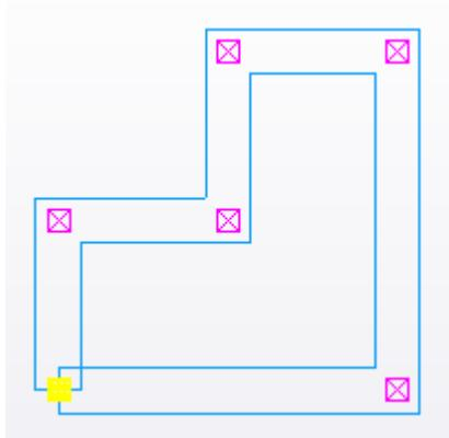
Кроме того, если смоделировать составную балку так, что ее торцевая грань будет обращена к стороне этой же составной балки, Tekla Structures не сможет создать сплошную конструкцию, и в модели и на чертежах будет отображаться кромка.
