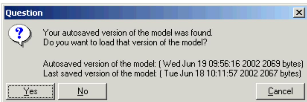
Если Tekla Structures выводит сообщение **Неустранимая ошибка: Память модели повреждена при считывании**, это означает, что в результате аппаратного сбоя база данных моделей была повреждена. Возможно, поврежден жесткий диск. Для восстановления модели можно использовать файлы автосохранения или системные резервные файлы.
