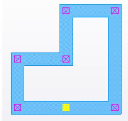
Если начать моделирование из угловой точки, в углу составной балки будет отсутствовать фрагмент, а другой фрагмент будет накладываться на противоположный торец. В таком случае Tekla Structures не сможет создать составную балку как твердотельный объект.
