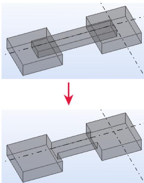
В видах моделей монолитные бетонные конструкции можно просматривать как детали или как объекты заливки. Переключаться между этими режимами просмотра можно с помощью команды **Вид заливки** на вкладке **Бетон** или настройки представления детали **Монолитный** в диалоговом окне **Показать**.
